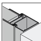
Esecuzione telaio a blocco
