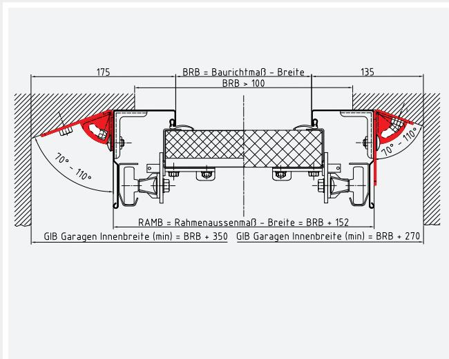
Horizontalschnitt, Einbau hinter der Öffnung
