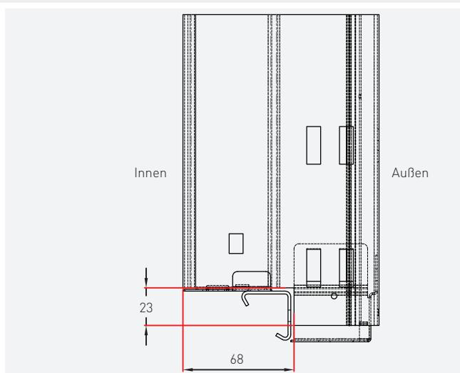
Abgestufte Winkelzarge zur Überbrückung von Bodenschienen
